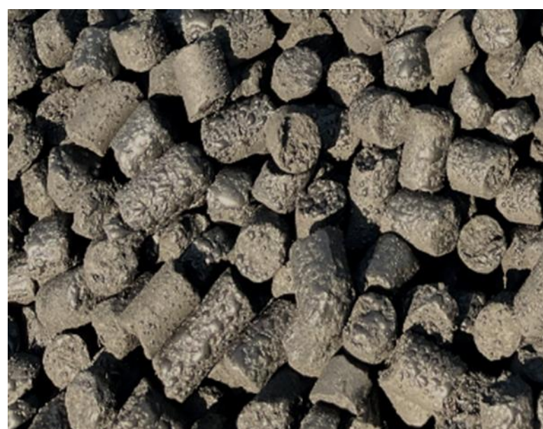
実証試験で使用したバイオマス(BP：ブラックペレット)
