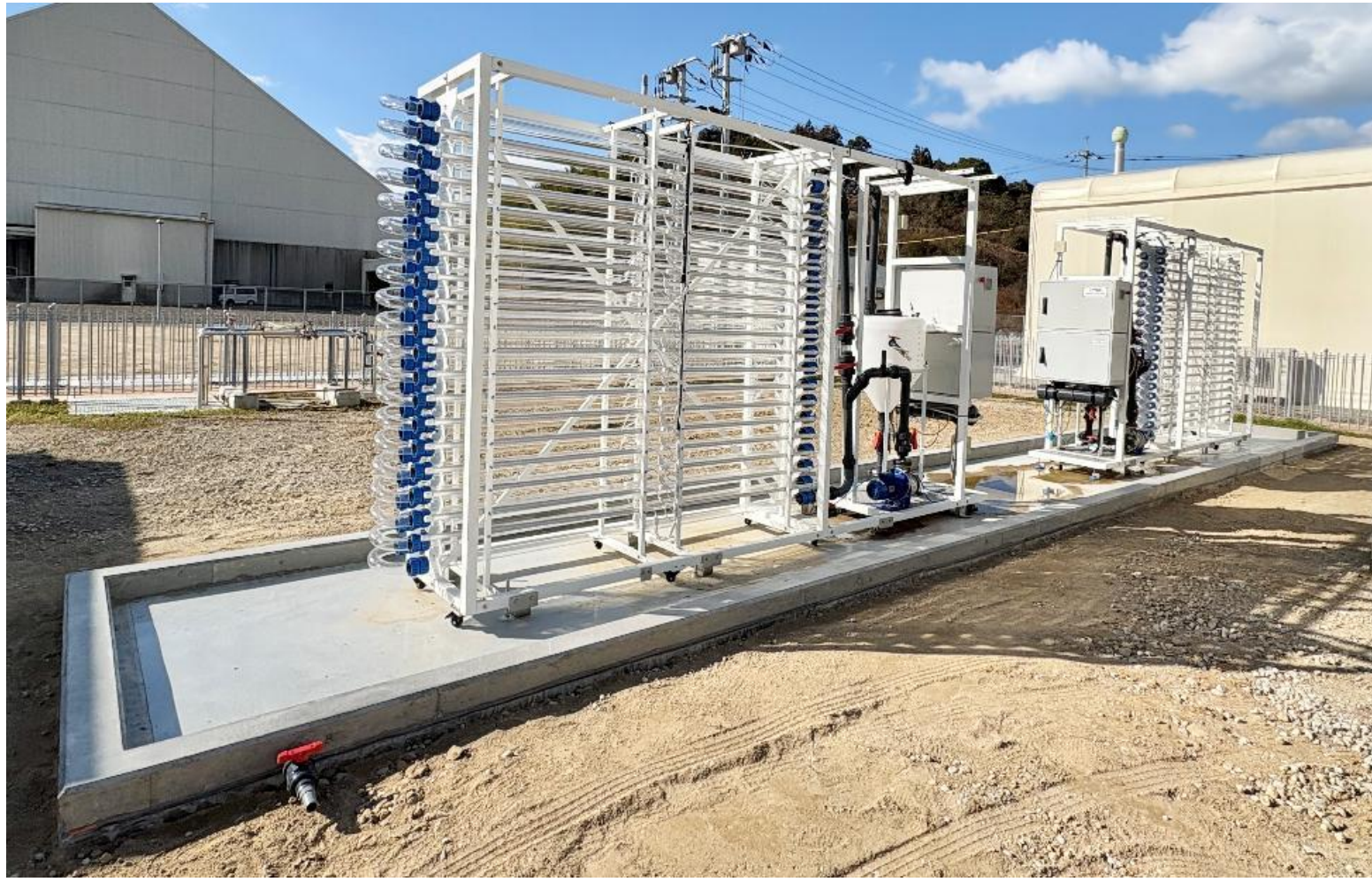
屋外に設置した300 L-PBR培養装置
