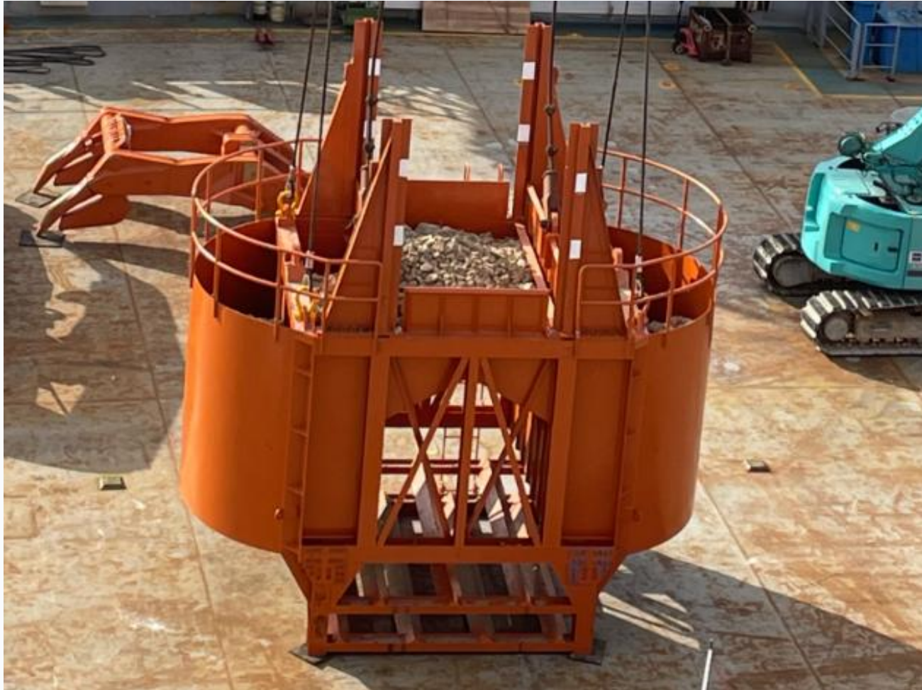
写真. 碎石防護装置
