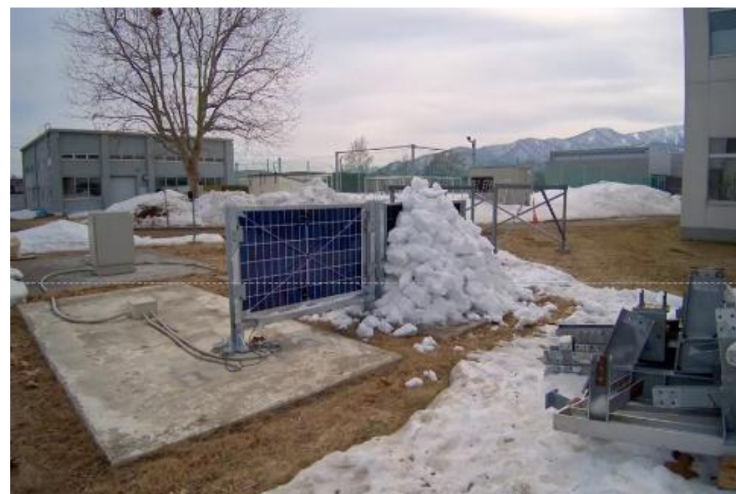
垂直設置の積雪荷重測定装置
