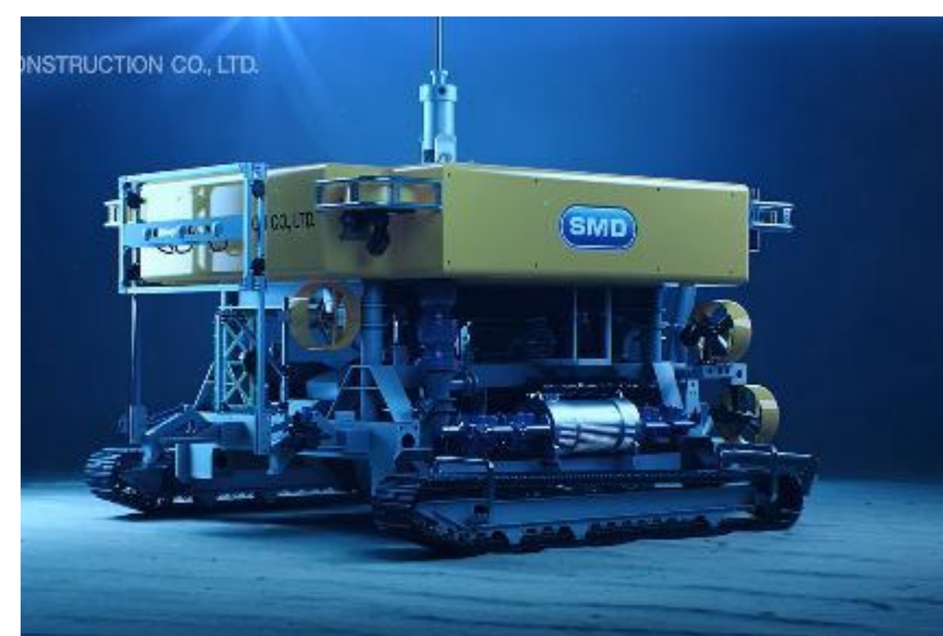
海底ケーブル埋設機（イメージ図） (参考) SMD社より提供
