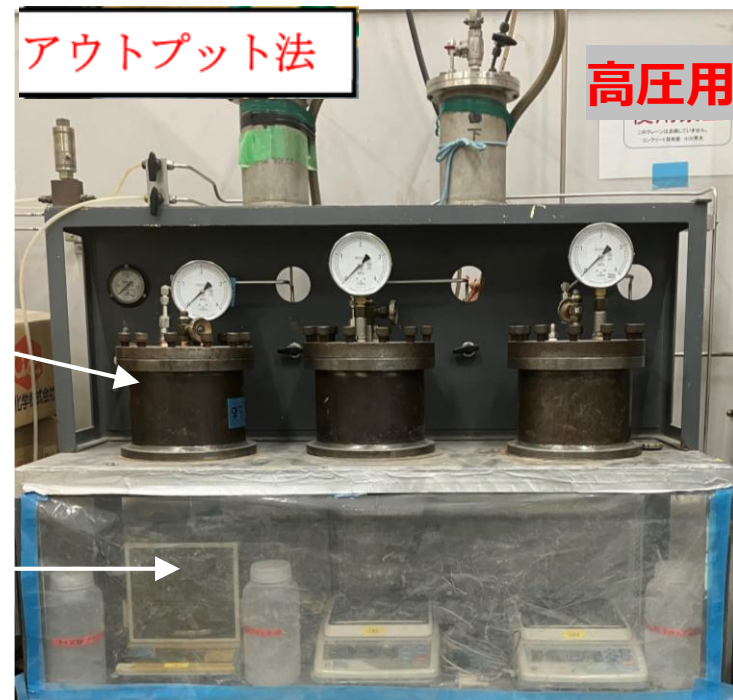
透水試験状況
