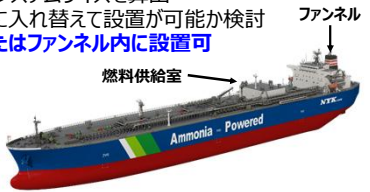
中型アンモニア燃料船(貨物積載 約40,000 m 3 )への搭載設置案
