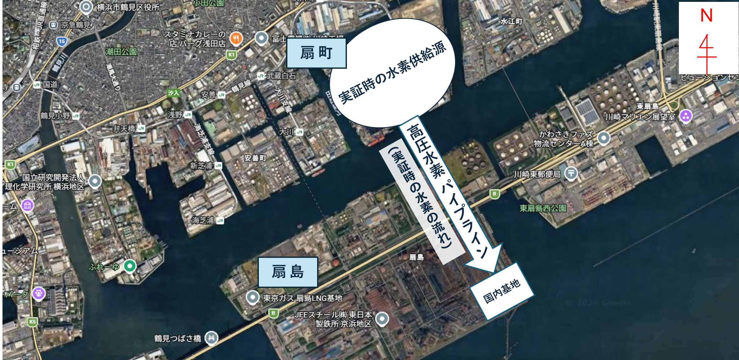
図④ 実証時におけるパイプラインを通した水素供給の模式図（出典：Google Map）
