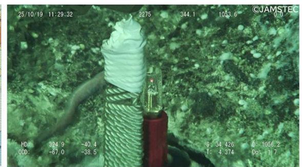
海底熱水の熱エネルギーによるLED点灯写真 (2026/2/26 商船三井プレスリリースより)
