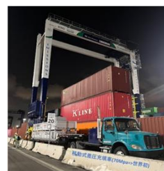
FC-RTGCに水素充填する超高压移動式水素充填車
