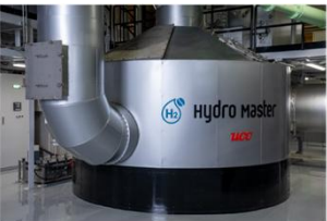
【工業用スケール水素焙煎機・脱炭機】 400kg/B 年間最大焙煎量6,000 t
