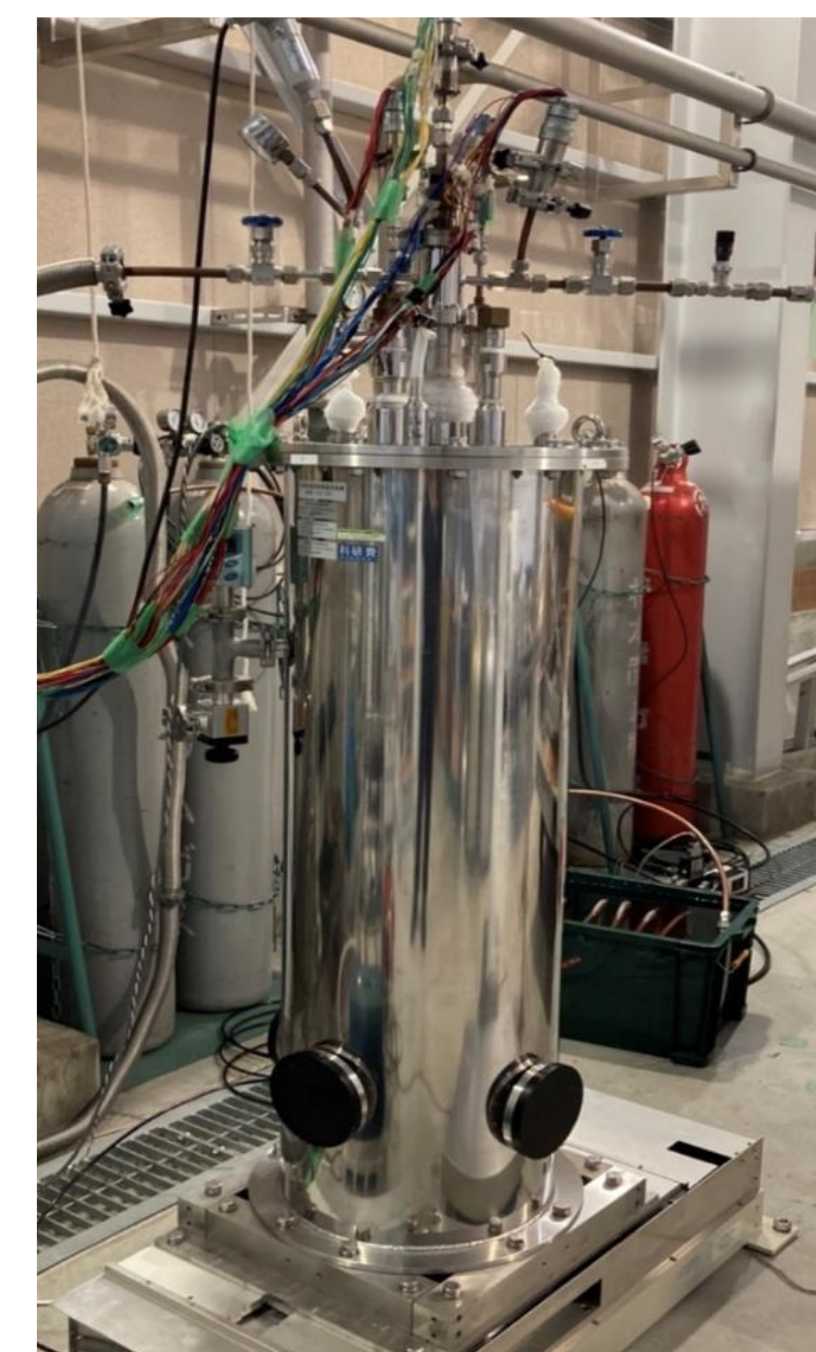
図5 光学クライオスタット 液体水素供給設備 (神戸大)
