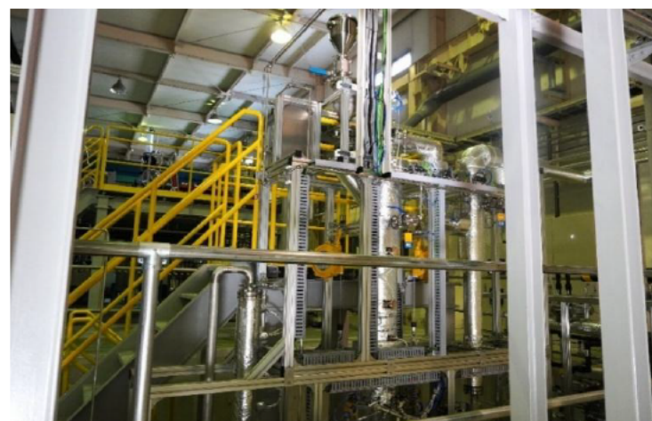
還元剤活性化/ \text{CO}_2 分解用流動層装置
