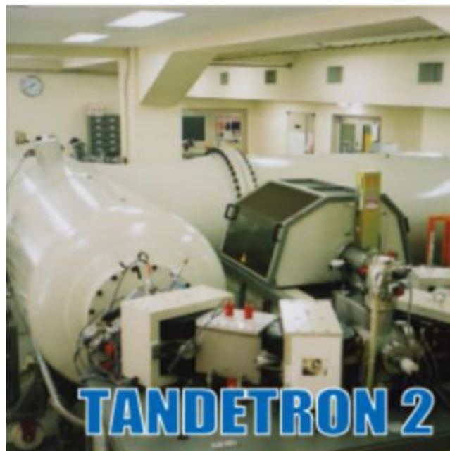
図：名古屋大学・宇宙地球環境研究所 タンデトロン年代測定研究グループ所有の炭素同位体測定装置
