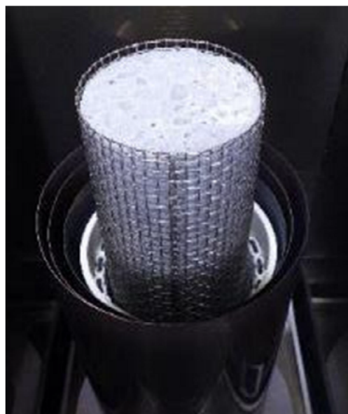
装置内にセットした コンクリート試験体
