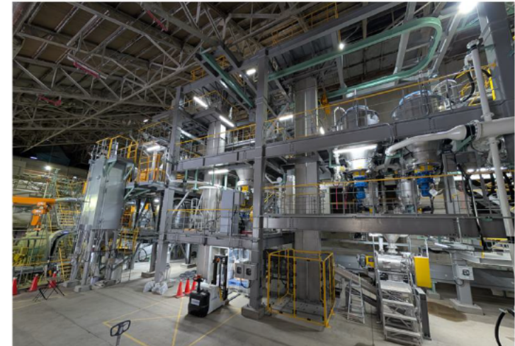
キルン外観 ・内径 0.45m ・全長 8m 設備全景
