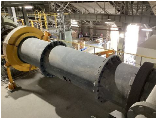
キルン外観 ・内径 0.45m ・全長 8m 設備全景
