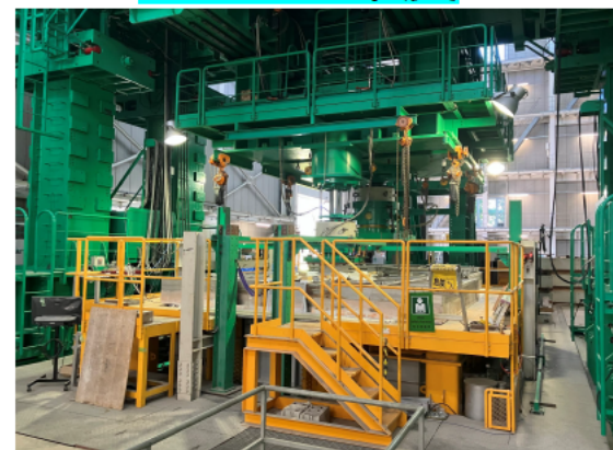
耐火実験炉(柱)
