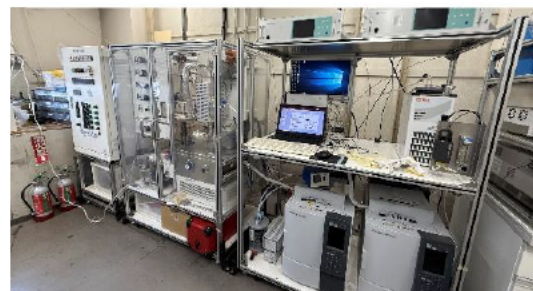
加圧流通型触媒固定床反応器
