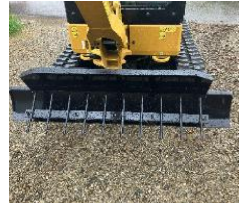
排土板を改造
