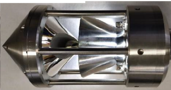
側方視タイプのカメラ センサー部
