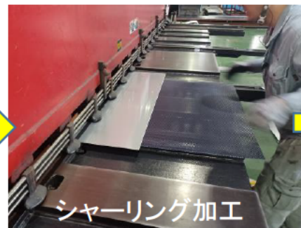
選択吸収膜付きアルミ板のエキスパンドメタル加工
