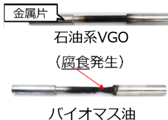
熱交試験後の 金属腐食
