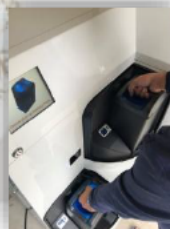
可搬型蓄電池シェアリング 実証（インドネシア）
