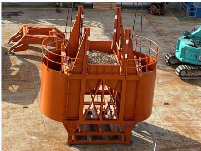
写真. 碎石防護装置
