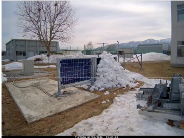
図 積雪荷重測定装置および積雪の沈降力の測定結果
