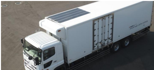
商用車へのPV搭載例 (約200台の実証データ取得)
