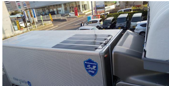
商用車へのPV搭載例 (約200台の実証データ取得)
