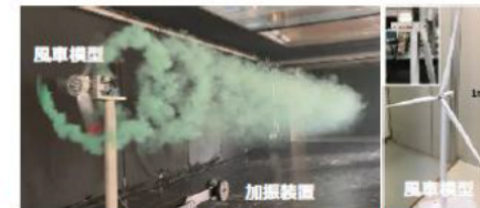
図2 浮体動揺を模擬した風洞実験
