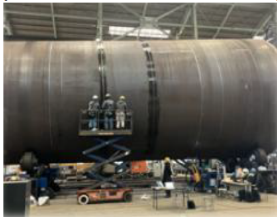
従来工法 MUT※ (※資格者による超音波探傷)
