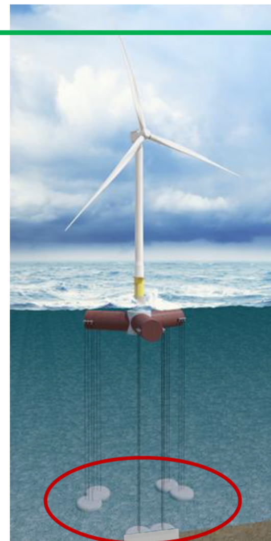
大水深無人化施工 (アンカー施工を対象)
