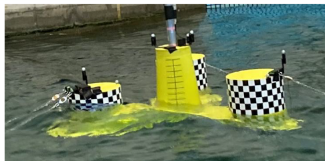
水槽実験 (1/64スケール模型)
