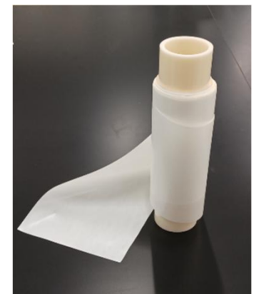
試作AEM膜の外観 (80um × 25cm × 30m)
