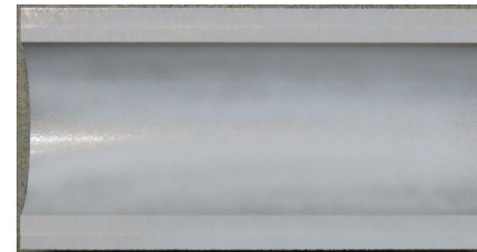
開発材の試作品の内面加工後の浸透探傷試験結果 →きず指示なし
