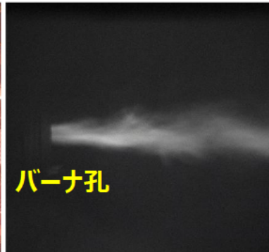
Fig. ガラス溶解炉内のNH 3 火炎画像（OHラジカル発光）*東北大撮影
