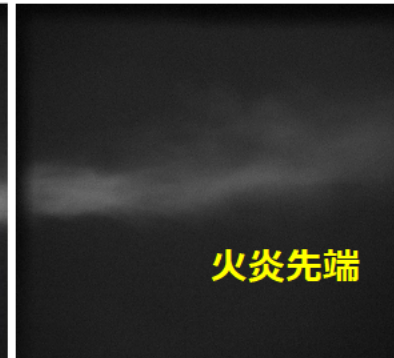
Fig. ガラス溶解炉内のNH 3 火炎画像（OHラジカル発光）*東北大撮影
