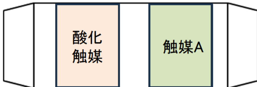
③NH3酸化触媒+鉄ゼオライト触媒(NH3注入あり)
