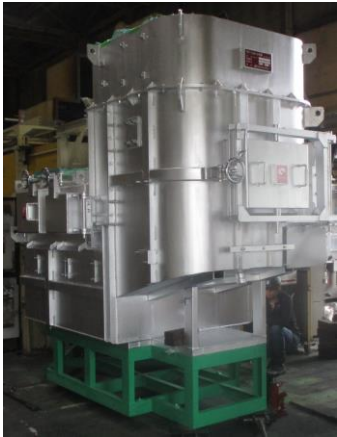
溶解炉の設置
