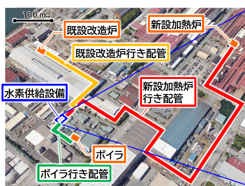
図：ボイラ，加熱炉向け燃料供給配管
