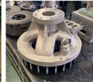
カーゴポンプ 吐出マニフォールド
