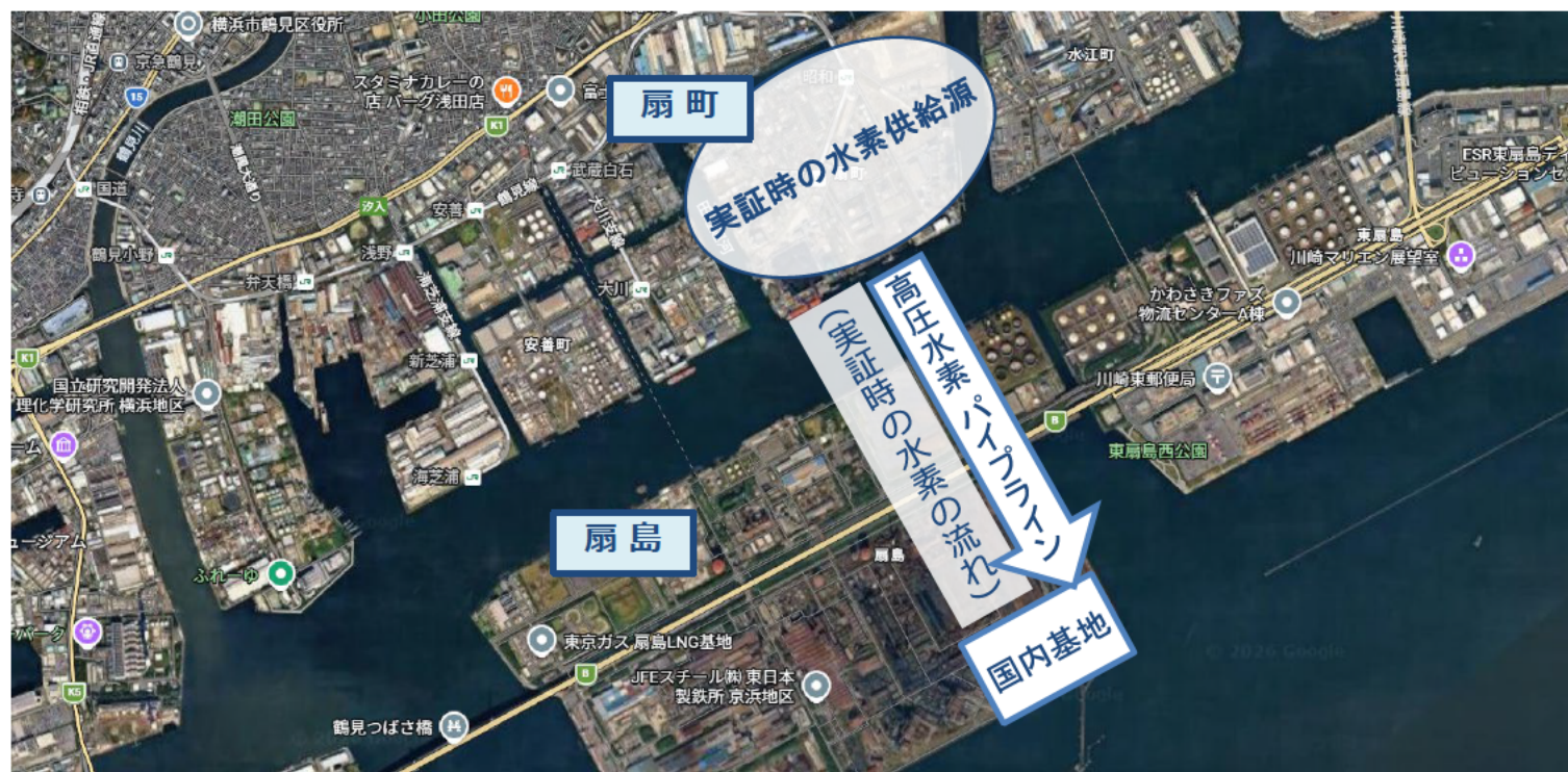
実証時におけるパイプラインを通じた水素供給の模式図 (出典：Google Mapを加工して作成)
