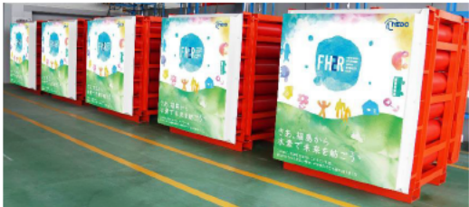
カードル（水素貯蔵量：300 m3）
