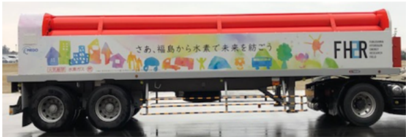
トレーラー（水素貯蔵量：3,000 m3）
